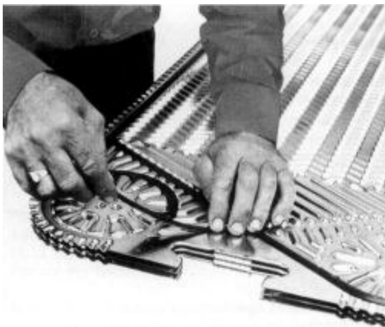
Rys. 18: Wklejanie uszczelki na płytę.
