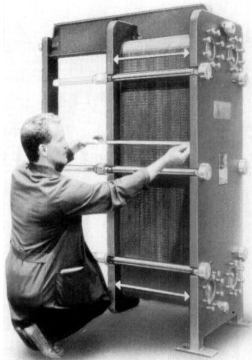
Rys. 15 sprawdzanie wymiaru skręconego wymiennika
